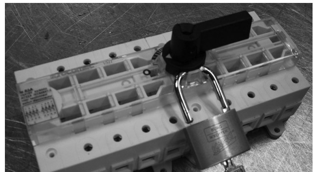
Kuva 8. Kytкин lukittu OFF-asentoon
